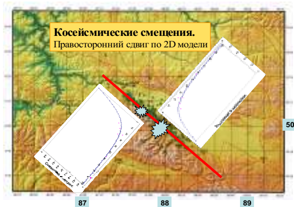
Рис. 6. Теоретическое распределение горизонтальных смещений в эпицентральной зоне и экспериментальные данные
